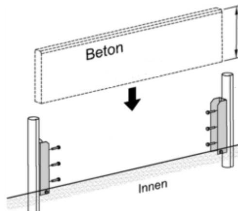
Dieser Fertigteil Zaunsockel ersetzt das aufwändige betonieren oder mauern einer herkömmlichen Gartenmauer, als Abschluss des Zaunes.
